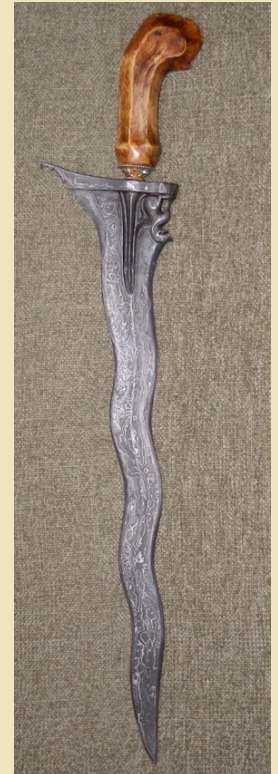
Klinge aus Damaszener Stahl, 17. JH n. Chr., Kohlenstoffnanoröhrchen
