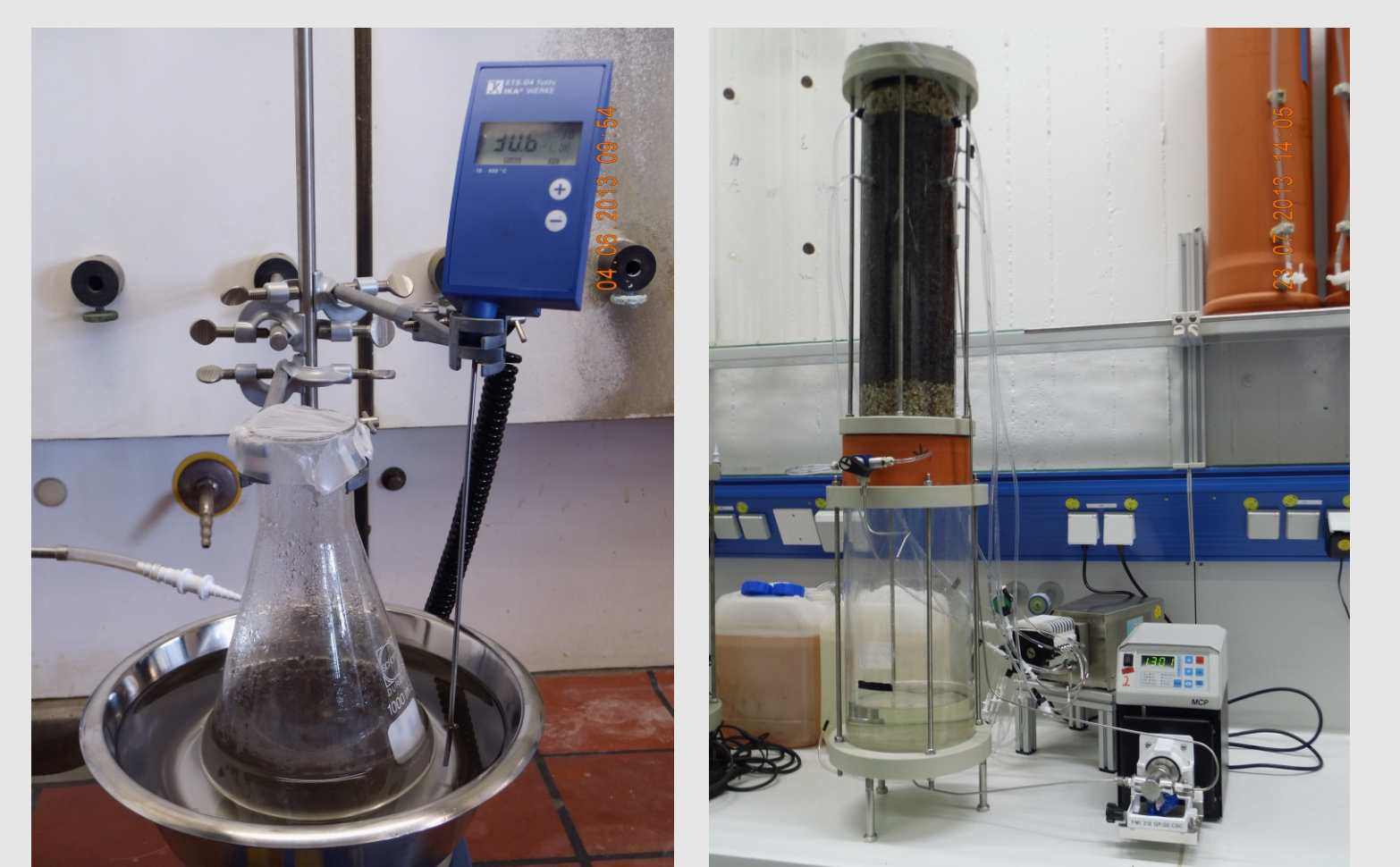
Abb. 3: Batch- und Säulenversuche im Labor der Ruhr-Universität-Bochum.
