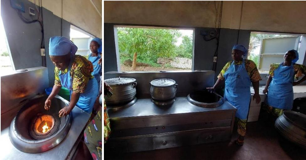
Abb. 22 und 23: Aus Lehm gebauter Ofen, der mit Ölpalmkernschalen befeuert wird und bei dem die Luftzufuhr mit Hilfe eines manuell zu betreibenden Schwungrades geregelt wird.
