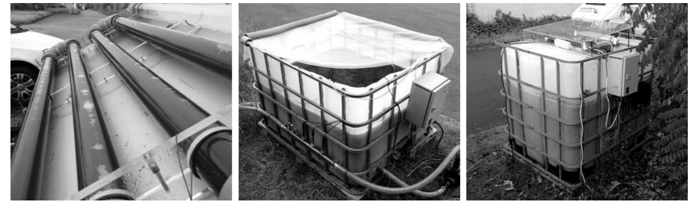
(3) Links: Rohrphotobioreaktor, Mitte: offener Wassertank IBC, rechts: Wassertank IBC mit Leuchtstoffröhren. Quelle: Pozza [20]
