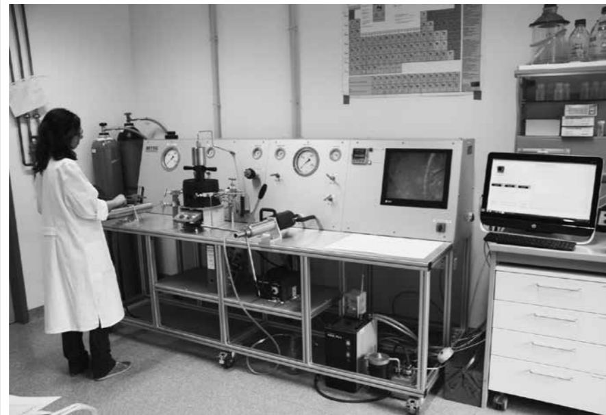
(1) Hochdruckanlage zur Simulation von Verhältnissen innerhalb der Erdkruste bis 10 km Tiefe. Die eigentliche Hochdruckzelle befindet sich in dem schwarzen Zylinder links von der Bildmitte. Sie erlaubt die kontinuierliche Beobachtung von Reaktionen sowie die Zugabe und Entnahme von Substanzen bei einem konstanten Druck von bis zu 1.000 bar. Quelle: Ulrich Schreiber, auf dem Bild zu sehen ist Dr. Maria Davila Garvin
