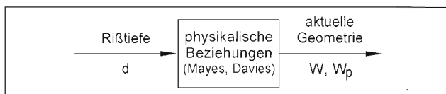
Bild 7: Herstellen der Beziehung Rißtiefe - Widerstandsmomente.
