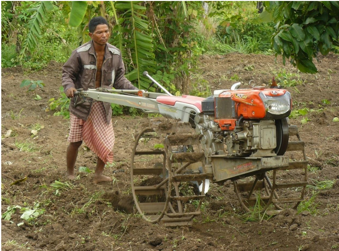
Abb. 1: Multifunktioneller Handtraktor – für viele Haushalte in Kambodscha eine typische Investition zwischen 1.200 und 1.800 USD, für die sie einen Kredit aufnehmen müssen.
