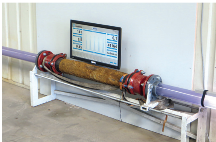
Abb. 10: Reale Rohrleitungsprobe in der Versuchsanlage
