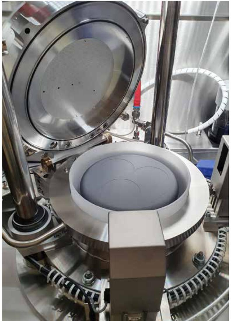
Reaktor der Metallorganischen Gasphasenepitaxie zur Herstellung der Halbleiterschichten (MOVPE)
