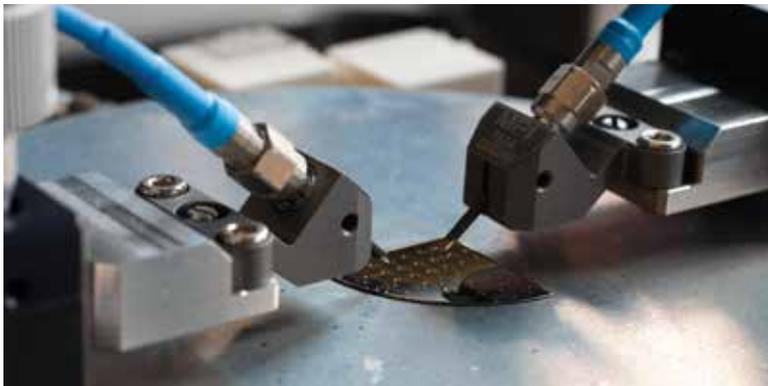
*On-Wafer-Messungen zur Charakterisierung von im Reinraum hergestellten THz-Bauelementen und -Schaltkreisen*
