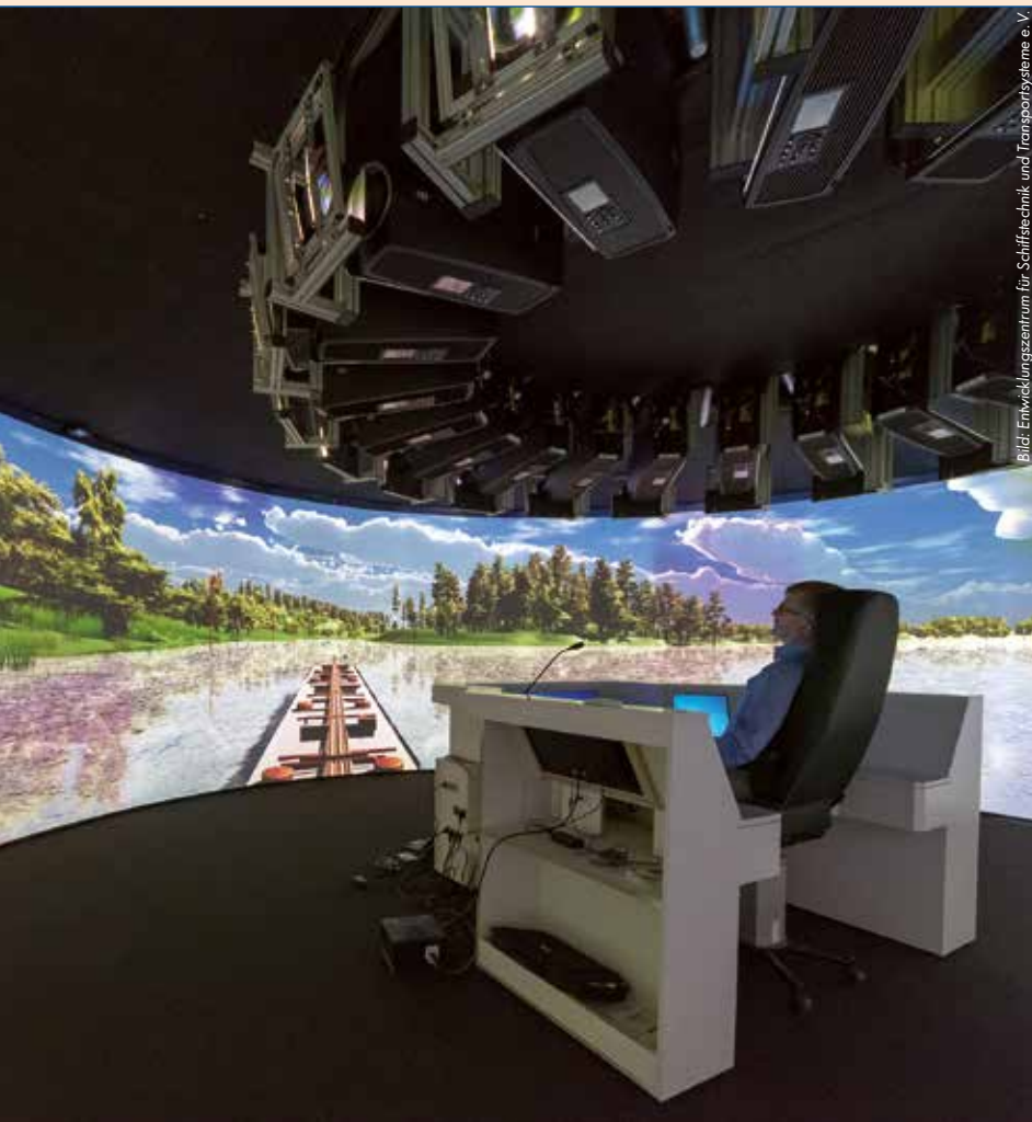
Fahrstand im DST-Versuchs- und -Leitungszentrum für autonome Binnenschiffe
