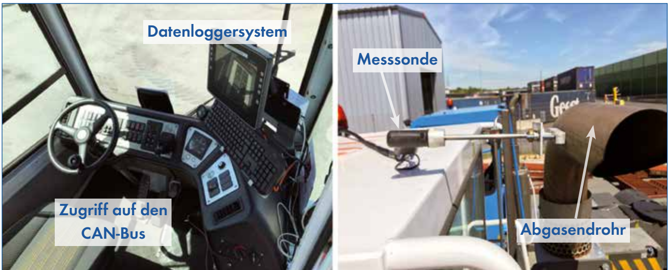
Eingesetzte Messtechnik beim Terminaltraktor
