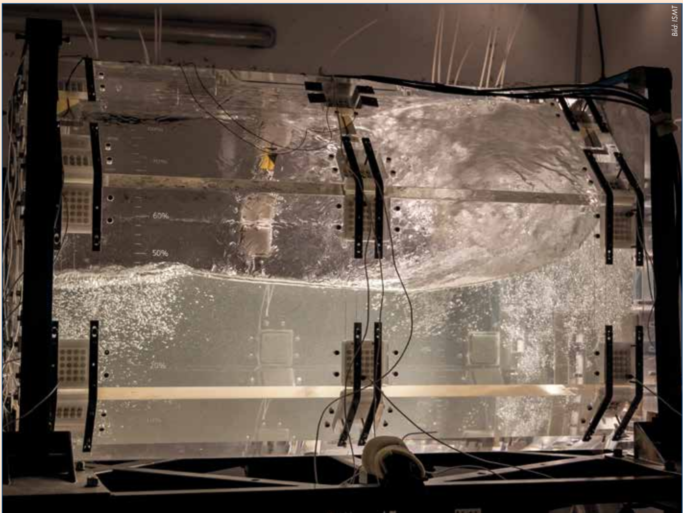
Untersuchung von Sloshing in einem teilgefüllten Tank für Flüssiggas
