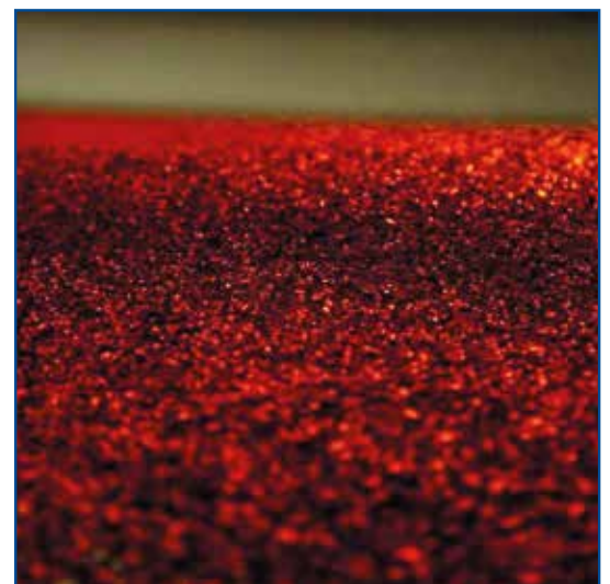
Hochlegierte Stahlspäne nach der Reinigung, bereit für die Wiederverwendung im Betrieb
