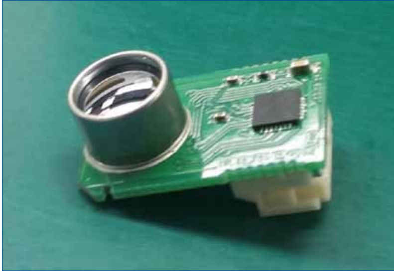
Intelligente Infrarotsensormodule zur Präsenz- und Bewegungserkennung
