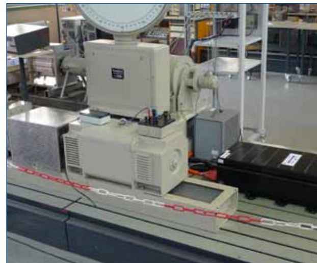
Power-Prüfung: Die Lithium-Ionen-Batterie auf dem Teststand
