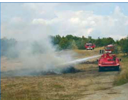
Ein Kettenlöschfahrzeug (KLF) der Firma Airmatic beim Löscheinsatz in Hemer. Das umgebaute Bundeswehr-Fahrzeug vom Typ „Marder“ verfügt über hervorragende Geländegängigkeit und eine wassersparende Hochdruckwirbeltechnik. Das KLF besitzt flexible Tanks, die schnell geleert werden können, um so bei Rettungseinsätzen für bis zu 20 Personen Platz zu schaffen. Nachdem der Brand gelöscht ist, übernimmt das Luftschiff die Nachsorge. (Fotos: GSW-Consulting)
