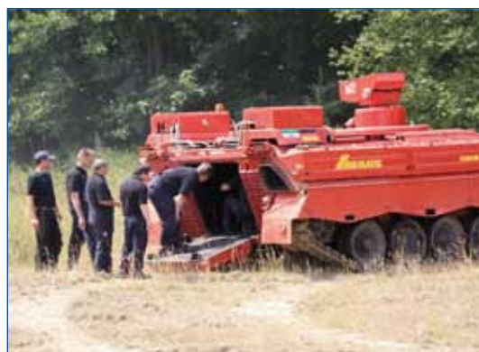
Ein Kettenlöschfahrzeug (KLF) der Firma Airmatic beim Löscheinsatz in Hemer. Das umgebaute Bundeswehr-Fahrzeug vom Typ „Marder“ verfügt über hervorragende Geländegängigkeit und eine wassersparende Hochdruckwirbeltechnik. Das KLF besitzt flexible Tanks, die schnell geleert werden können, um so bei Rettungseinsätzen für bis zu 20 Personen Platz zu schaffen. Nachdem der Brand gelöscht ist, übernimmt das Luftschiff die Nachsorge. (Fotos: GSW-Consulting)
