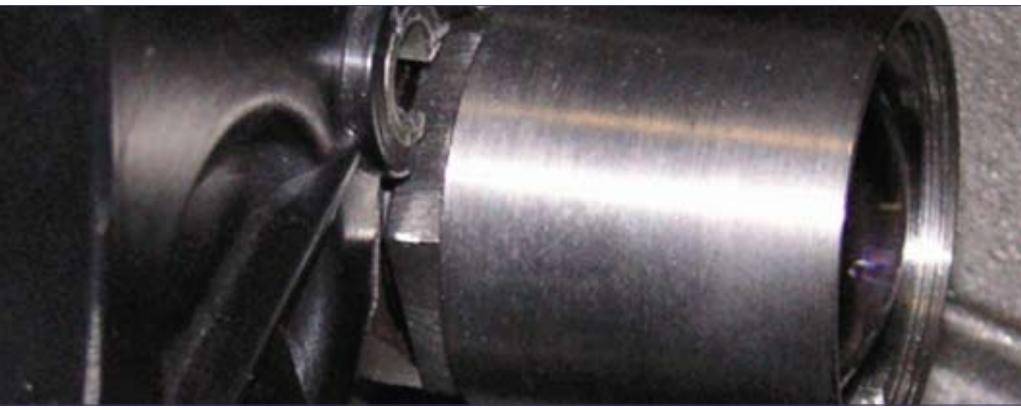
Im Serienmotor montiertes Endoskop zur Messung der Kraftstoffverteilung (Foto: Universität Duisburg-Essen/IVG)
