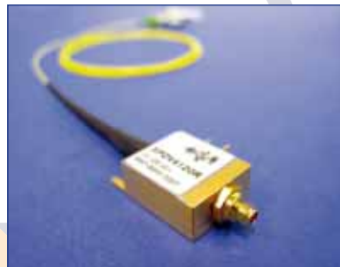
Weltweit einzigartig: die 110-GHz-IPHOBAC-Photodiode als Chip (links) und als Modul (rechts)
