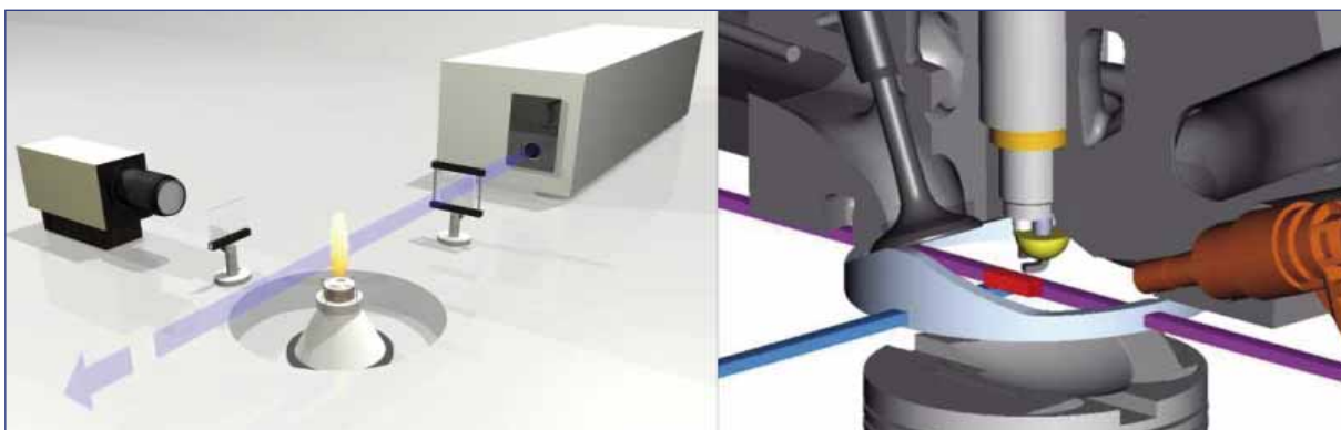
Anordnung der abbildenden Lasermesstechnik in Flammen (links) und Motoren (rechts)
