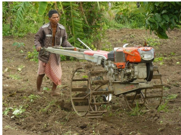
Foto 4: Handtraktor, wie er in sehr vielen vor allem kleinbäuerlichen Haushalten vorhanden ist – ein Multifunktionsgerät, das umgebaut auch als Zug„maschine“ für Karren Verwendung findet
