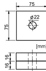
(d) Test specimen with one M20 bolt
