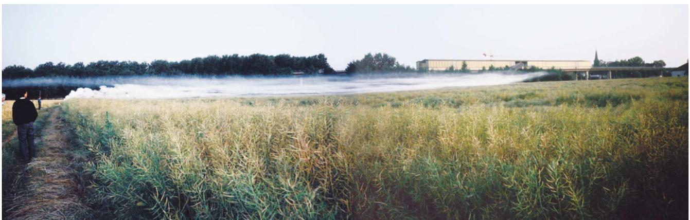
Abb. 2-5: Visualisierung der Kaltluftausbreitung mit Hilfe von Raucherzeugern. Man beachte die in der linken Bildhälfte erkennbare gegenläufige Ausgleichsströmung an der Oberseite der Rauchfahne (Foto: Kuttler).
