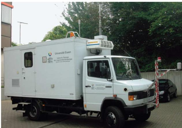
Abb. 2-3: Mobiles meteorologisch-lufthygienisches Labor der Abteilung Angewandte Klimatologie der Universität Duisburg-Essen. Messgrößen: Lufttemperatur, Luftfeuchtigkeit, Wind, Luftdruck, UV- und Globalstrahlung, NO, NO<sub>2</sub>, CO<sub>2</sub>, O<sub>3</sub>, VOC (Foto: Kuttler).
