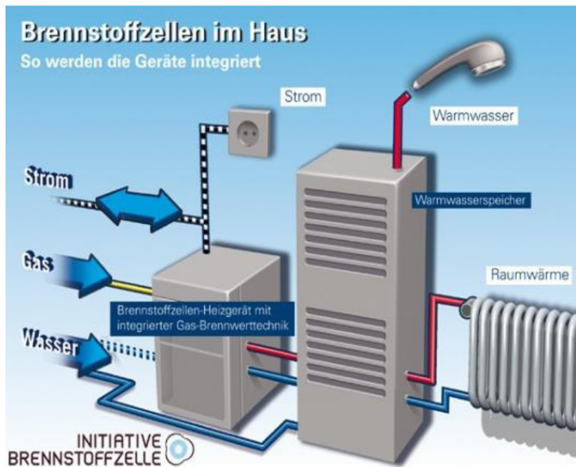
Abbildung 4: Funktionsprinzip der Kraft-Wärme-Kopplung zur Hausenergieversorgung [21]
