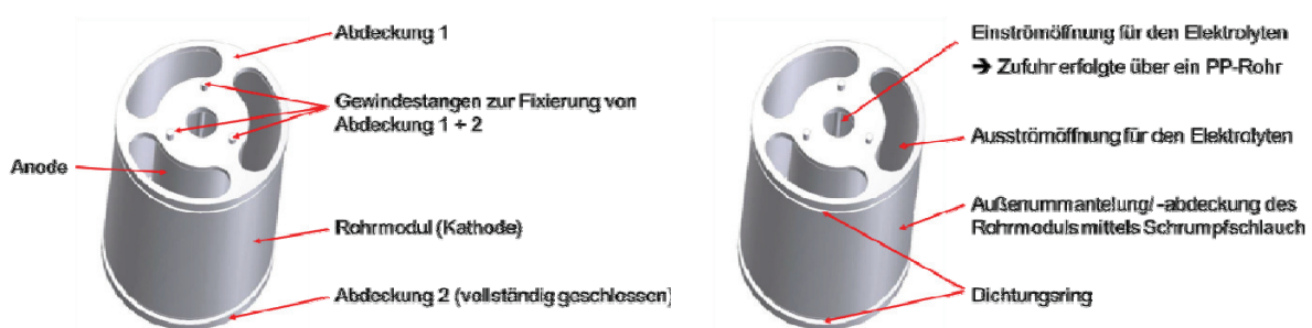
Abb. 4.7-5: Vorrichtung zur Beschichtung des Rohrmoduls mit Nickel und Palladium
