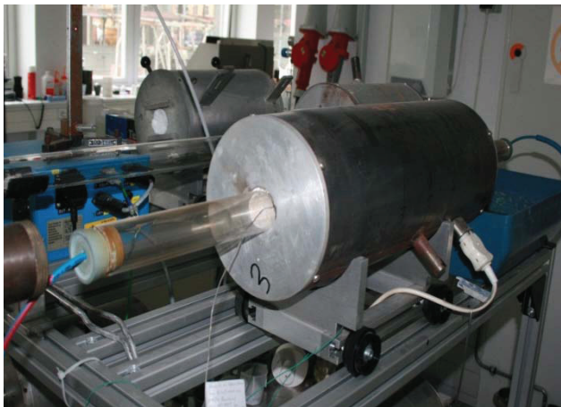
Abb. 4.3-1: Röhrenofen zur Wärmebehandlung der Multilayer
