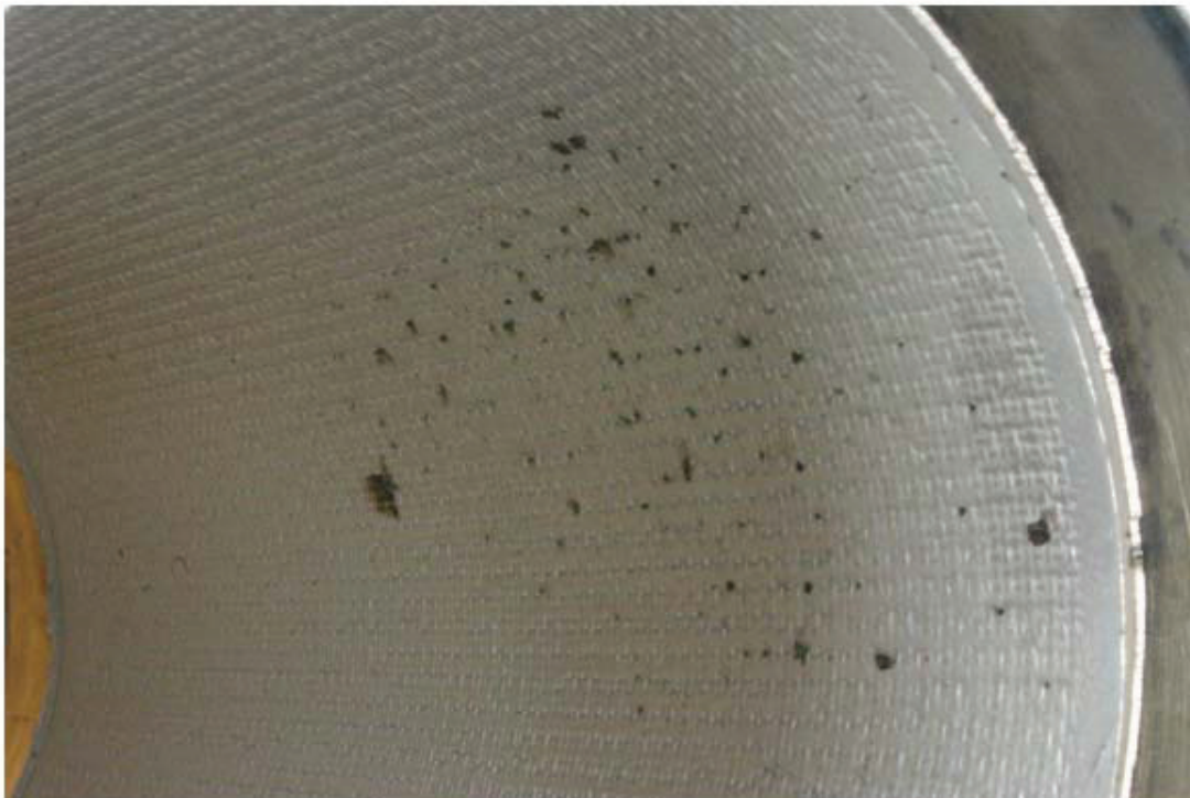
Abb. 4.7-13: Beschädigungen der Rohrmembran nach Ausbau aus der Testkammer
