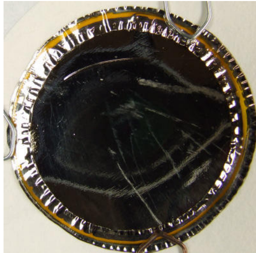
Abbildung 3.16: Intakte Metallschicht einer PdAg-6FDA-4MPD Membran (iii) ohne Plasmabehandlung nach einem einwöchigen Dauerversuch bei 200 °C und einem H 2 -Feeddruck von 9 bar
