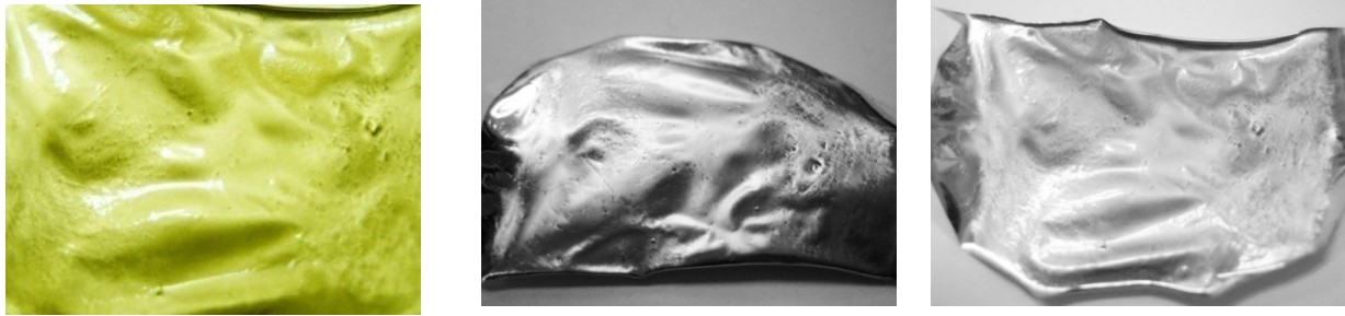
Abbildung 3.45: Beschädigte Kunststoffolie PI-03 (nach der Beschichtung mit Sputterleistung 175 W)
