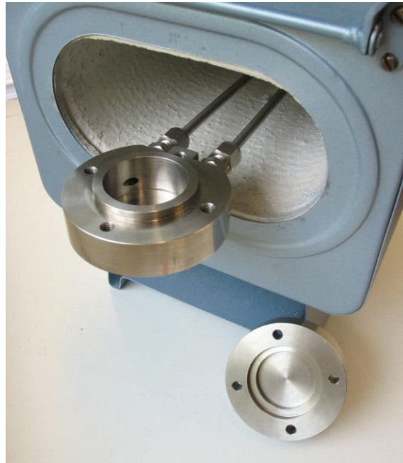
Abbildung 3.30: Muffelofen mit Temperungszelle
