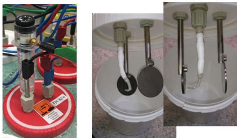
Abbildung 79 Messaufbau für die elektrochemischen Tests in 7 M (30 Gew.-%) KOH bei 60 °C, Halbzellen-Konfiguration mit Edelstahl-Gegenelektrode und H 2 -Referenzelektrode (Gaskatel®)
