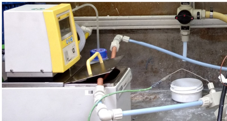
Abbildung 13 Temperaturkontrolliertes Wasserbad mit Kupfer-Spirale
