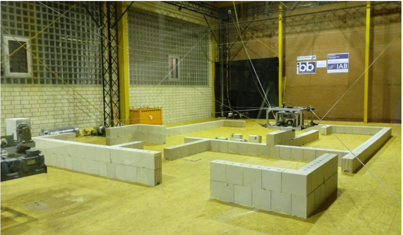
Abbildung 1: Seilroboter für die Erstellung von Kalksandstein-Mauerwerk
