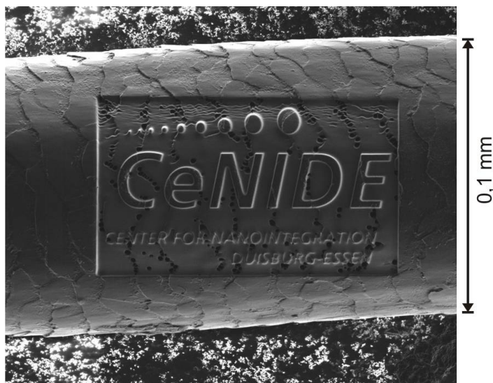
Abbildung 1.1: Detailansicht eines menschlichen Haares: Bearbeitet mit einem fokussiertem Ionenstrahl (FIB) vom Cenide Zentrum, und abgebildet mit einem Elektronenmikroskop. Entnommen aus [a1]
