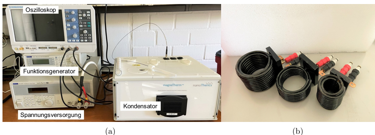
Abbildung 3.7: (a) Hyperthermie-Messaufbau. (b) Linke Spule mit w=18 , d_i=44 mm, mittige Spule mit w=9 , d_i=44 mm, rechte Spule mit w=18 , d_i=25 mm.
